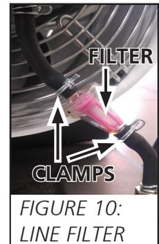
**CLEANING THE INTAKE FUEL FILTER (HSP100ID, HSP200ID, HSP300ID)**
